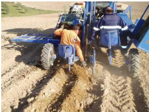
**Figura 4.10** - Pormenor de funcionamento do plantador
