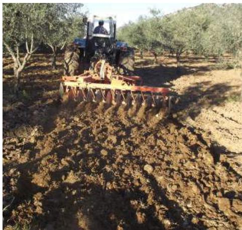
**Figura 4.4** - Regularização superficial do solo com grade de discos
