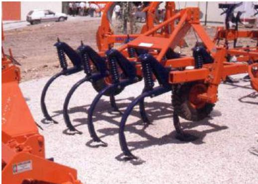
**Figura 4.1** - Chisel para preparação do solo sem inversão de leiva
