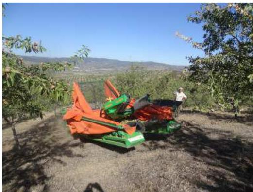
**Figura 12.10** - Vibrador de troncos com aparta frutos fechado permitindo a deslocação do equipamento (Foto R. Tranchete)
