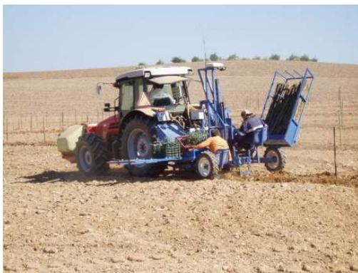
**Figura 4.9** - Plantador mecânico guiado por satélite
