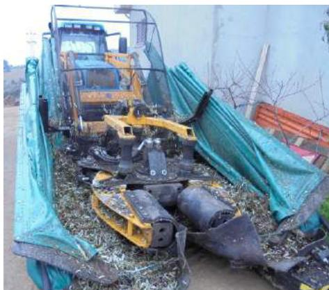
**Figura 12.1** - Aspeto de um vibrador de tronco
