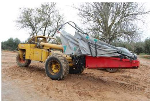
**Figura 12.3** - Vibrador de tronco automotriz com aparafusos
