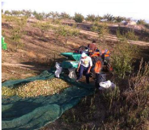
**Figura 12.15** - Equipamento de descasque de amêndoa acionado pela *t.d.f.* do trator
