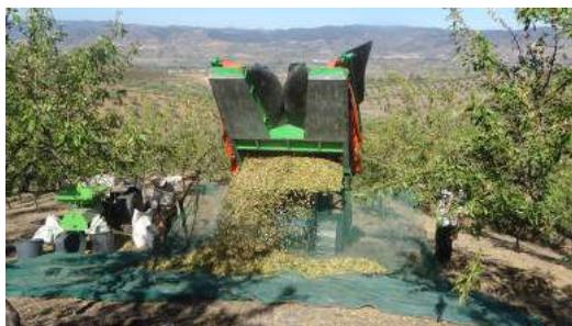
**Figura 12.12** - Descarga para lonas da amêndoa colhida com vibrador e aparta frutos (Foto R. Tranchete)
