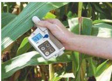
**Figura 7.1** – Medidor de clorofila SPAD-502 Plus que estima o teor de clorofila nas folhas medindo a transmitância da luz através da folha em dois comprimentos de onda, 650 nm (luz vermelha absorvida pela clorofila) e 940 nm (luz infravermelha não absorvida pela clorofila)
