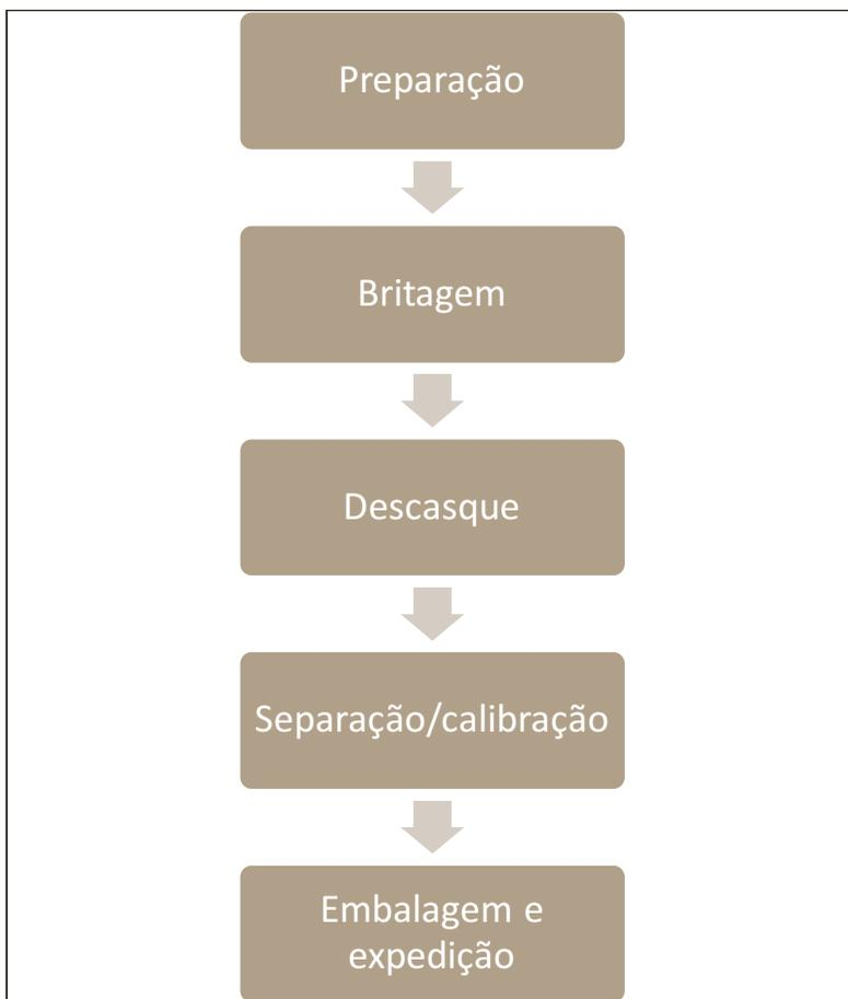
**Figura 24** - Processamento tecnológico de preparação de noz sem casca.
