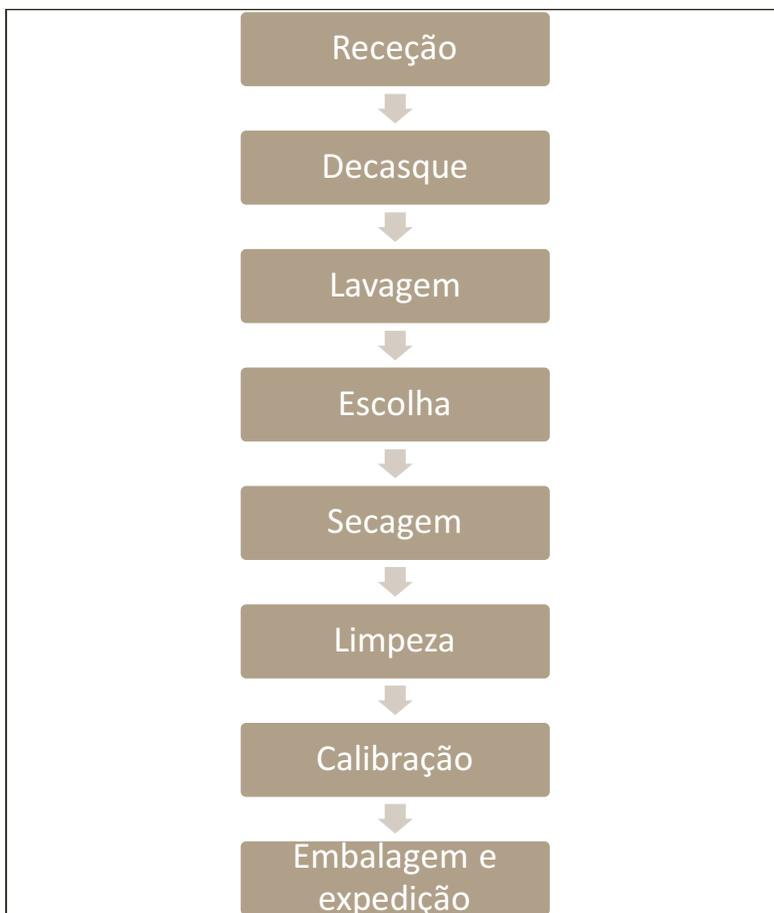
**Figura 1** - Processamento tecnológico de preparação de noz com casca.
