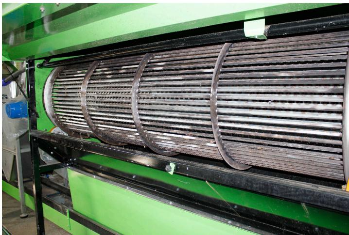
**Figura 2** - Descascador para remoção do mesocarpo.
