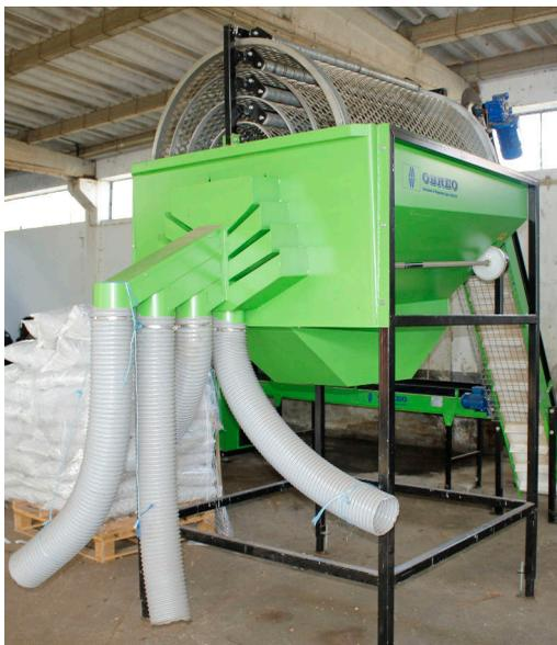
**Figura 4** - Calibrador para quatro calibres.
