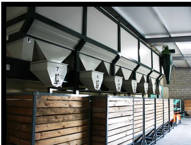
**Figura 4** - Sistema de calibração instalado na Empresa AgroAguiar, Vila Pouca de Aguiar (Arq. pessoal J. Gomes-Laranjo).
