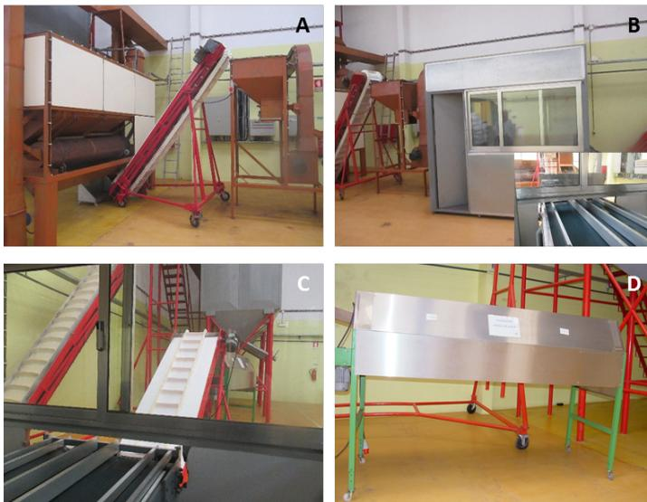
**Figura 9** - Linha de processamento de miolo de avelã: (A) Descascador; (B) Cabine de escolha manual; (C) Tapete transportador; (C) Calibradora de miolo
