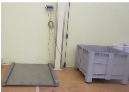
**Figura 4** - Balança para pesagem das avelãs
