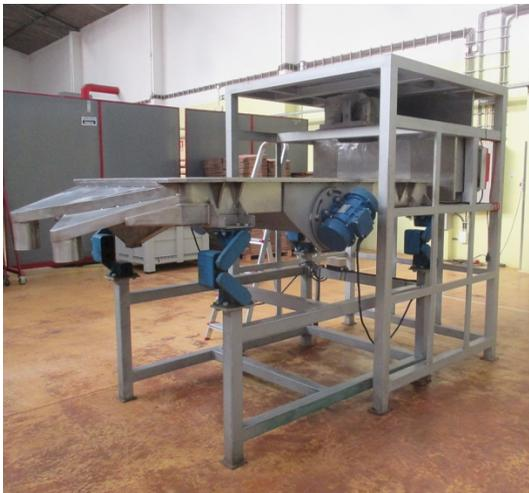
**Figura 12** - Equipamento de trituração e calibragem
