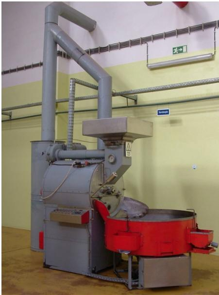
**Figura 11** - Equipamento de torrefação da avelã
