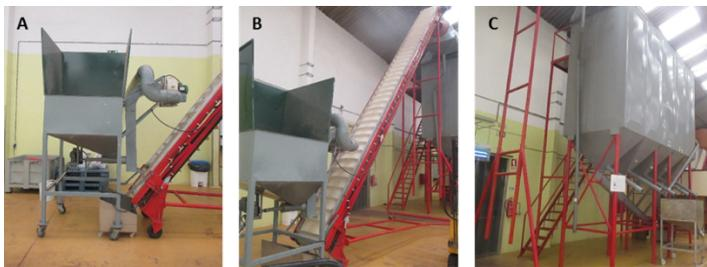
**Figura 5** - Limpeza, transporte e calibragem da avelã
